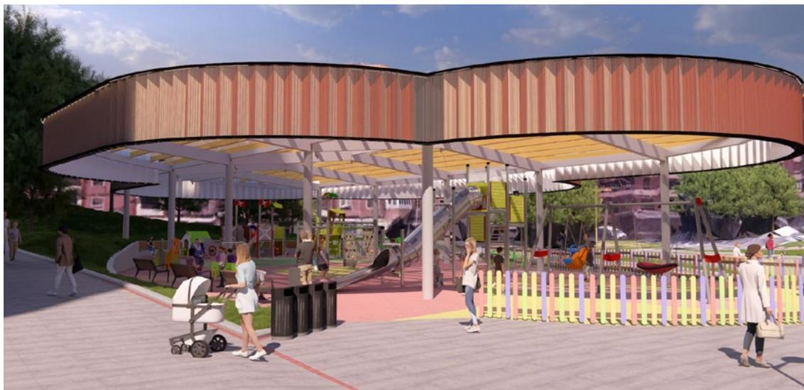
► La estructura de la nueva cubierta, que destacará por su singular geometría, se resolverá con perfilera metálica y policarbonato compacto.
