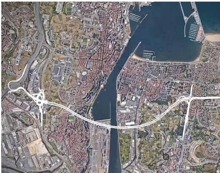
➤ La ortofoto muestra el trazado del túnel subterráneo, que tendrá una longitud de 3.037 metros.
